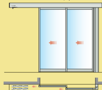
Teleskopska jednokrillna vrata bez bočne stijene (prikaz lijevog otvaranja)
